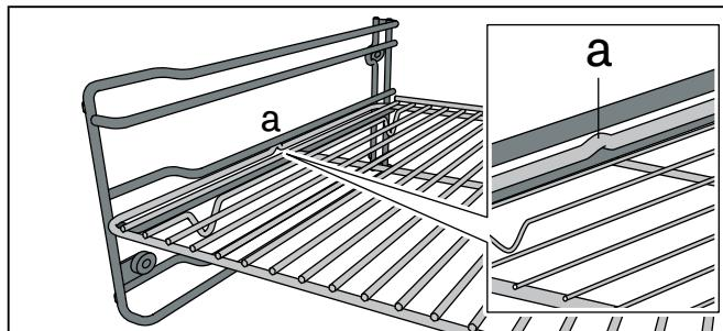
При установке лотка без отверстий следите за тем, чтобы фиксирующий выступ (а) был обращён наверх.
