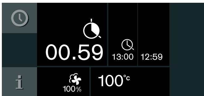
По окончании времени приготовления прибор выключается. Мигает символ ☰ и раздаётся звуковой сигнал. Звуковой сигнал выключится раньше, если нажать символ ✓, открыть дверцу прибора или повернуть переключатель выбора функций на 0.
